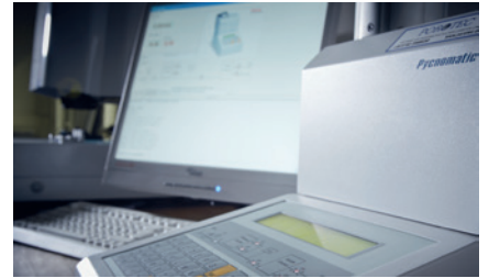
Picnometro a gas per la misurazione della densità dei vostri componenti di serie.
