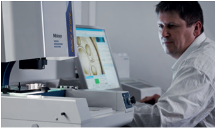
Appareil de mesure optique pour déterminer les dimensions du calibre de contrôle de vos composants.
