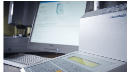
Gaspycnometer zur Messung der Materialdichte Ihrer Serien- bauteile.
