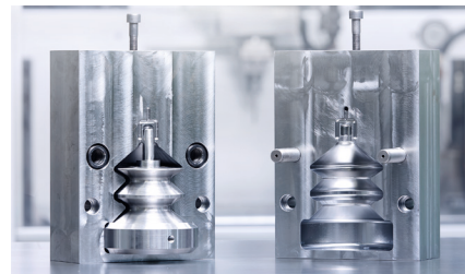
Flexibilität, Innovation und eine hohe Fertigungstiefe werden bei uns groß geschrieben. Elastomerwerkzeug eines Faltenbalgsaugers entwickelt, konstruiert und gefertigt im Hause der Zimmer Group
