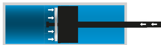
Amortyzator podczas ruchu roboczego
