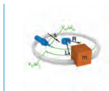
R6.在形状决定的传动力矩作用下水平摆动的物体
